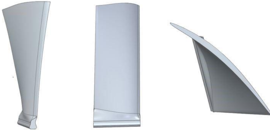
Figur 8: CAD bild av den resulterande fläktbladgeometrin
