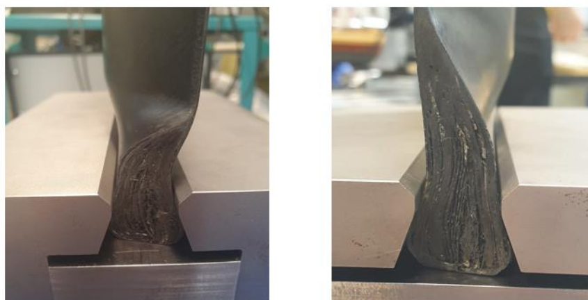
Figur 16: Närbild på rotsektionen med synliga defekt i laminatet
